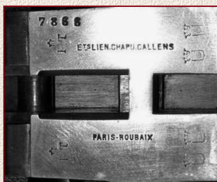
Илл. 2. Подушки коробки другого ружья, аналогичного двустволке Сазонова, с опознавательной маркировкой торгового акционерного общества Ets. LIEN.CHAPU.CALLENS и парижские испытательные клейма
